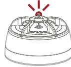
Beachten Sie bitte, dass die Warmmelder bei aktiviertem „Lernmodus“ nicht in den Montagesockel eingesetzt werden können. Nehmen Sie die Batterie im „Lernmodus“ nicht heraus, das unterbricht den Lernvorgang.
