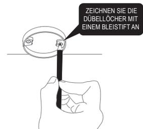
Benutzen Sie den Montagesockel, um die Dübellöcher an der Decke oder an der Wand zu markieren.
