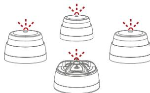
Blinkt die rote LED bei allen Warmmeldern, sind sie vernetzt; DER „LERNMODUS“ MUSS AUSGESCHALTET WERDEN und die Installation beginnen.
