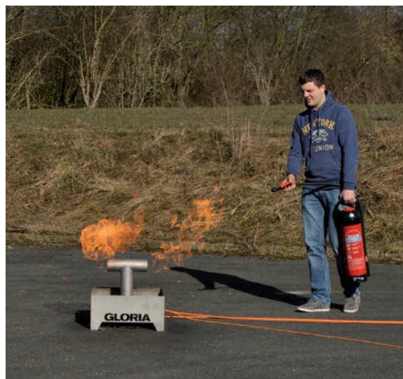
Löschangriff am Rohrbruch
